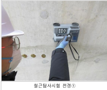
〈사진 3.31〉 철근탐사시험(부산) 전경
