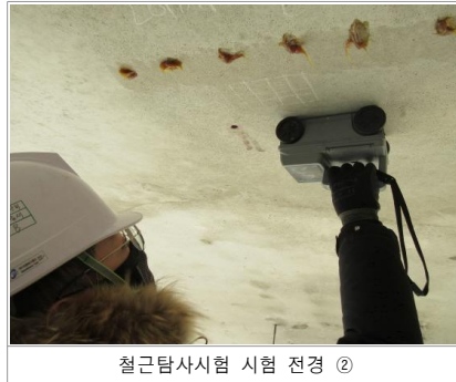
〈사진 3.36〉 철근탐사시험(포항) 전경
