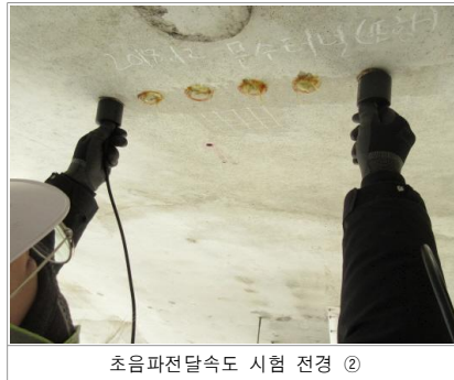
〈사진 3.35〉 비파괴시험법에 의한 콘크리트 강도조사 전경
