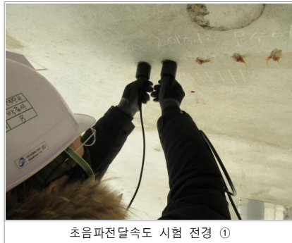
〈사진 3.35〉 비파괴시험법에 의한 콘크리트 강도조사 전경
