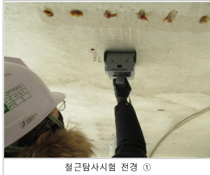
〈사진 3.36〉 철근탐사시험(포항) 전경
