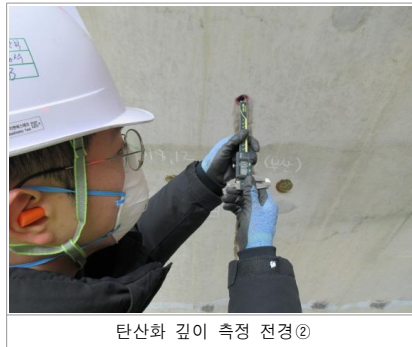
〈사진 3.32〉 탄산화 깊이 측정 전경
