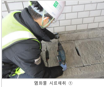
〈사진 3.38〉 염화물함유량(포항) 시험 전경
