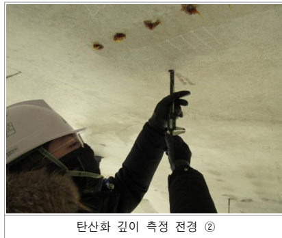
〈사진 3.37〉 탄산화 깊이(포항) 측정 전경
