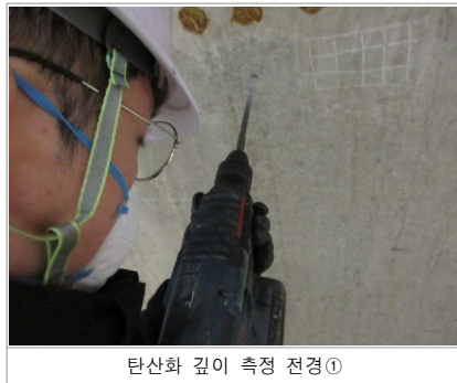
〈사진 3.32〉 탄산화 깊이 측정 전경
