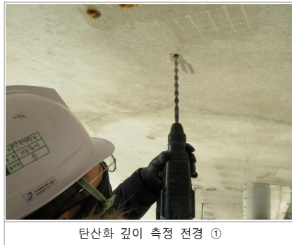
〈사진 3.37〉 탄산화 깊이(포항) 측정 전경
