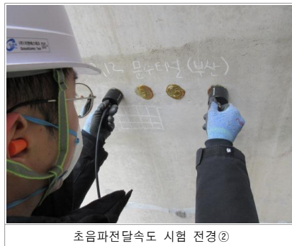
〈사진 3.30〉 비파괴시험법에 의한 콘크리트 강도조사(부산) 전경
