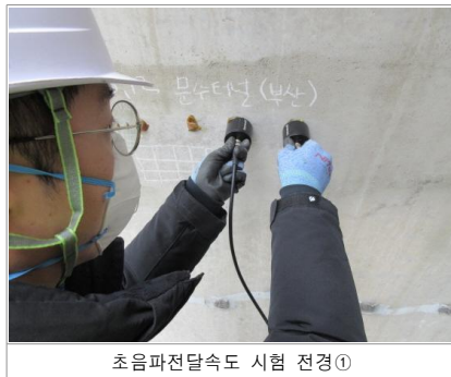
〈사진 3.30〉 비파괴시험법에 의한 콘크리트 강도조사(부산) 전경
