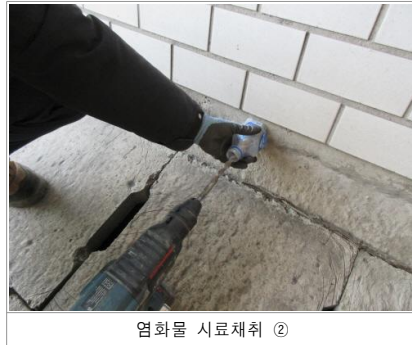
〈사진 3.38〉 염화물함유량(포항) 시험 전경
