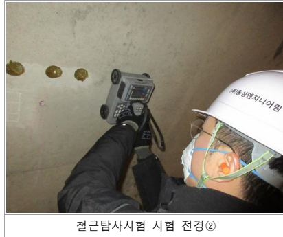
〈사진 3.31〉 철근탐사시험(부산) 전경
